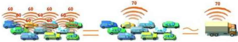
Figure 91 : Principe arithmétique du « bruit multiplié par 10 »
