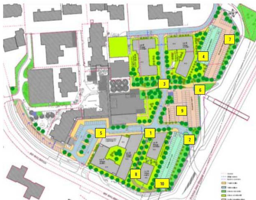
Figure 99 : Localisation des points de mesure du champ magnétique
