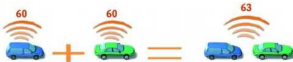
Figure 90 : Principe arithmétique du « bruit doublé »
